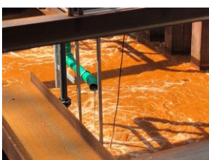
13.07.2021 Konditionierung mit Kalk
